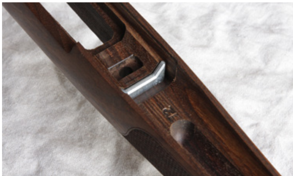
Detail vnútra pažby s kovovou vložkou
